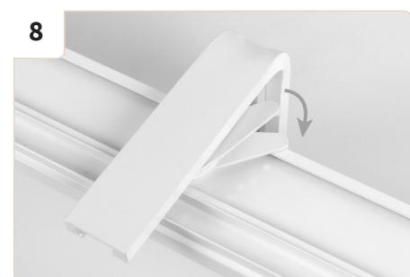
Začněte montáží levé kolejnice. Páčky držáků směřují ke stěně okna. Zvedněte kolejnici k úhlovému držáku tak, aby držáky seděly v drážce. Otáčejte páčkou na držáku, dokud nezapadne do kolejnice.
