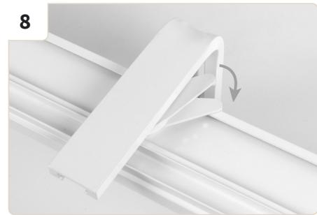
Iniziare con il montaggio della guida di sinistra. La levetta del supporto è orientata verso la parete della finestra. Sollevare il binario al supporto a parete in modo che si incastri nella scanalatura. Ruotare la levetta finché non si innesta nel binario.
