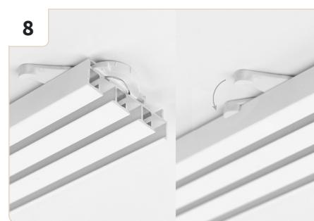
Rozpocznij od instalacji lewej szyny. Dźwignia uchwytu skierowana jest w stronę ściany okna. Podnieś szynę do sufitu, tak aby uchwyty znalazły się rowku. Obróć dźwignię w kierunku przeciwnym do ruchu wskazówek zegara, aż szyna toru zostanie zabezpieczona.
