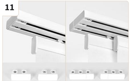
Führen Sie die Textilpaneele in der gewünschten Reihenfolge in die Schienen ein. Trennen Sie die benötigten Schienenabdeckungen ab und schrauben Sie diese an den beiden Schienenden fest.
