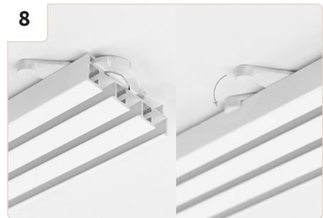
Comience con el montaje del riel de rodadura izquierdo. Los soportes de las ménsulas están alineados con la pared de la ventana. Levante la guía hacia el techo para que los soportes se asienten en la ranura. Gire el soporte en la abrazadera hasta que encaje en el riel.
