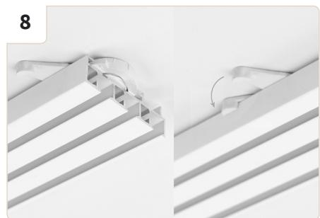
Iniziare con il montaggio del binario di sinistra. La levetta del supporto è orientata verso la parete della finestra. Sollevare il binario fino al soffitto in modo che il supporto si incastri nella scanalatura. Ruotare il supporto sulla levetta finché non si innesta nel binario.
