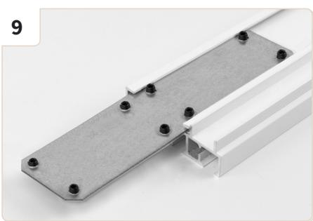
Montaż dodatkowych torów: z tyłnej strony lewego końca toru szyny włożyć łącznik w rowek do połowy i przymocuj go.
