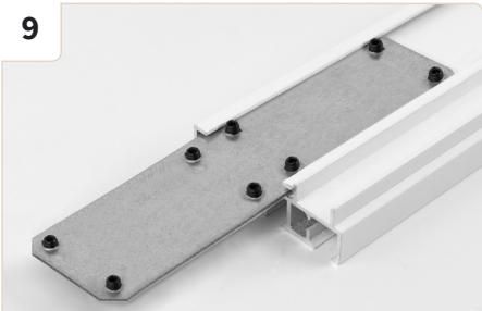
Montage weiterer Schienen: Schieben Sie das Verbindungsstück auf der linken Seite der nächsten Schiene zur Hälfte ein und schrauben Sie es fest.
