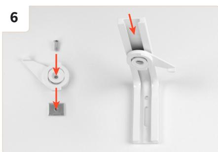
Připravte nástěnný držák podle obrázku 6 sešroubováním jednotlivých součástí k sobě (vlevo). Poté zavedte držák do úhlového držáku (vpravo). Pozor: Držák přišroubujte pouze tak pevně, aby s ním ještě bylo možné otáčet.
