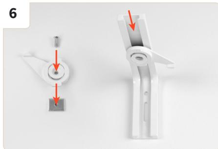
Prepare el soporte de pared como se muestra en la Fig. 6, atornillando los componentes individuales (izquierda). Después, introduzca el soporte en los ángulos (derecha). Importante: atornille el soporte sólo para que pueda seguir girando.
