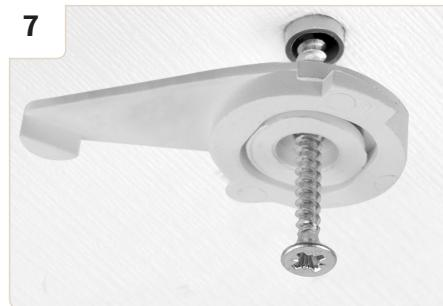
Perfore los agujeros adecuados para sus tacos y atornille el soporte. Apriete el tornillo solo lo suficiente para que el soporte pueda seguir girando con cierta fuerza.
