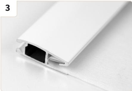
Repliez le renforcement pour bords vers l'intérieur dans la partie inférieure du tissu. Enfilez la barre de lestage sur un côté de façon que le tissu plié s'accroche derrière le bord métallique.
