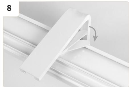
Comience con el montaje del riel izquierdo. Los soportes de las ménsulas están alineados con la pared de la ventana. Levante el riel de rodadura hasta el ángulo para que los soportes se asienten en la ranura. Gire el soporte en la abrazadera hasta que encaje en el riel.
