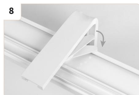
Begin met de montage van de linker looprail. De beugels van de houders zijn ten opzichte van de raamwand uitgelijnd. Til de looprail richting het plafond omhoog, zodat de houders in de groef zitten. Draai de houder op de beugel tot deze in de rail wordt vergrendeld.
