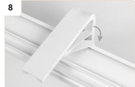
Commencez par monter le rail de gauche. Le levier du support est orienté vers le mur de la fenêtre. Soulevez le rail vers le support mural de sorte qu'il s'engage dans la rainure. Tournez le levier jusqu'à ce qu'il s'enclenche dans le rail.
